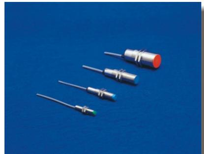
Os sensores indutivos de formato cilíndrico com rosca e conexão por conector M12, estão disponíveis nos diâmetros de 8 a 51mm, com distâncias sensoras que variam de 1 a 25mm, nos modelos NAMUR, ou corrente contínua com chaveamento NPN ou PNP, normal aberto, normal fechado, reversível ou corrente alternada (W) normal aberto, normal fechado ou reversível.
