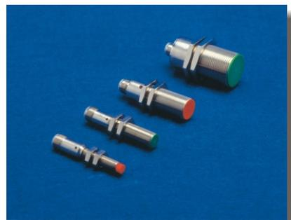
Os sensores indutivos de formato não tubular com conexão a cabo ou conector, estão disponíveis em vários formatos, com distâncias sensoras que variam de 1 a 25mm, podendo ser do tipo NAMUR, ou corrente contínua com chaveamento NPN ou PNP, normal aberto, normal fechado, reversível ou corrente alternada (W) normal aberto, normal fechado ou reversível.
